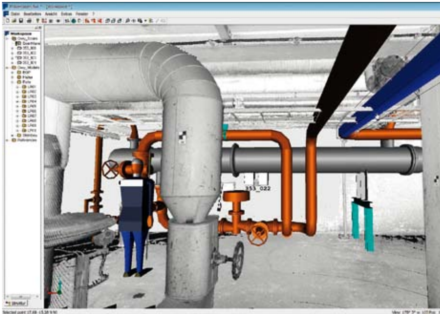
Im 3D-Planungstool CAD-Worx wird die Positionierung von Komponenten durch Tooltips vereinfacht
