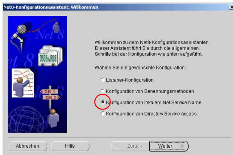
Der Net8 Konfigurations- Assistent unterstützt Sie bei der Einrichtung von Diensten und Benennungs- Methoden.
