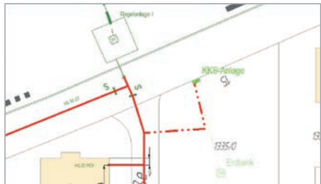
Bestandsplan mit Kathodenschutzanlage
