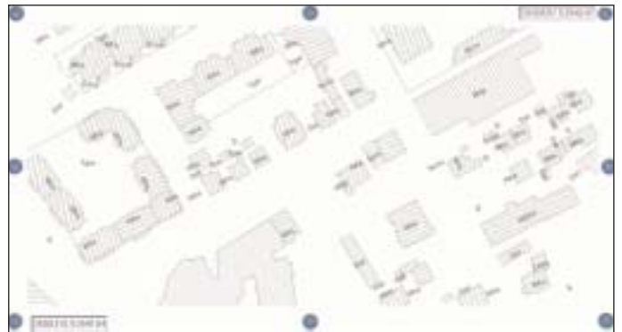
Abbildung 5.4: Gebäudeschraffuren Schraffuren auf einem ESRI ArcIMS ermöglichen im Zusammenspiel mit der ALK die Überprüfung der geometrischen Übereinstimmung von Daten aus verschiedenen Map Servern.
