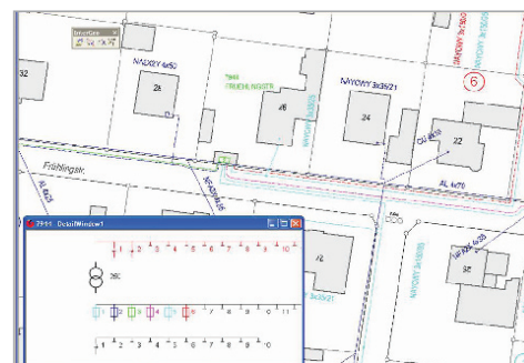
Stromkreisplan mit Innenleben der Trafostation
