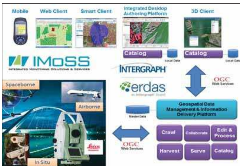
Figura 4 - Architettura di sistema integrata nelle soluzioni IMoSS.
